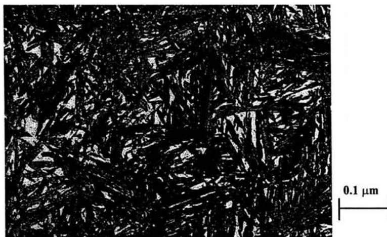
Figura 5.2 Fotomicrografía de la probeta de acero para herramientas AISI O1 templada en aceite quieto desde 950 °C. Para revelar la microestructura, la probeta se revinió a 200 °C durante 2 horas.
