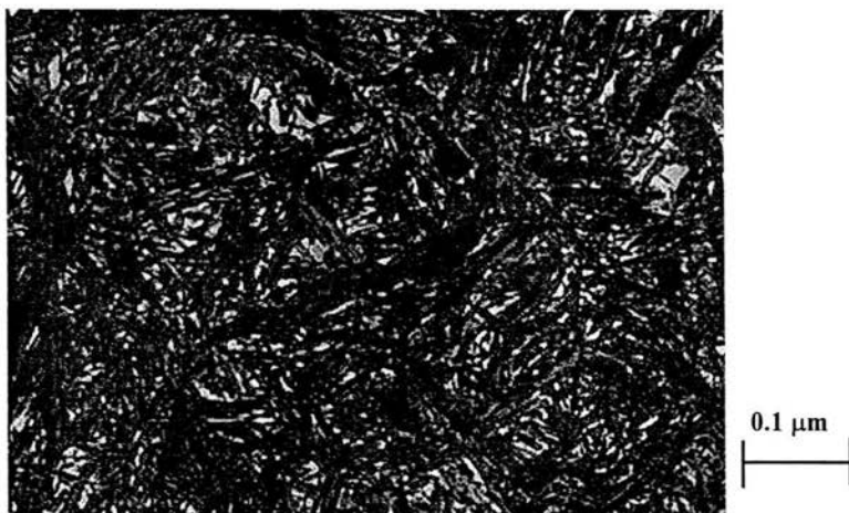
Figura 5.9 Fotomicrografía de la probeta de acero para herramientas AISI O1 sometida al tratamiento subcero a -20\text{ }^{\circ}\text{C} durante 2 horas. Para revelar la microestructura, la probeta se revinió a 200\text{ }^{\circ}\text{C} durante 2 horas.
