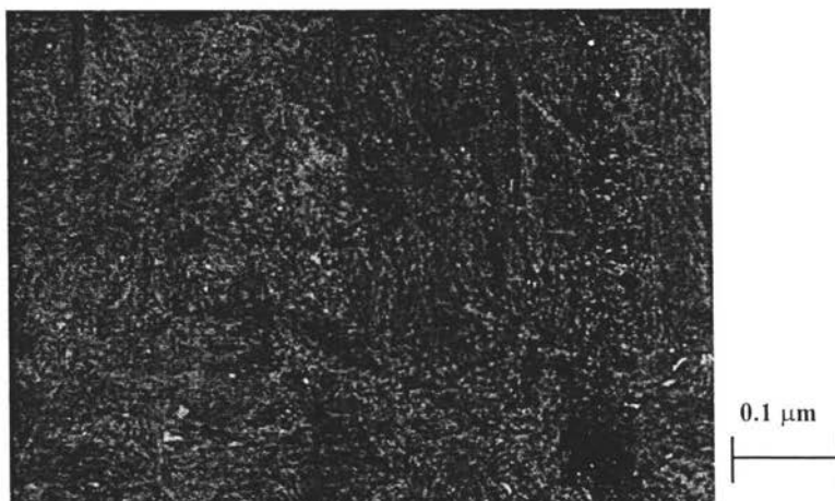
Figura 5.16 Fotomicrografía de la probeta de acero para herramientas AISI O1 templada y sometida al tratamiento subcero a la temperatura de -60\text{ }^{\circ}\text{C} durante 2 horas. Para revelar la microestructura, la probeta se revinió a 200\text{ }^{\circ}\text{C} durante 2 horas.
