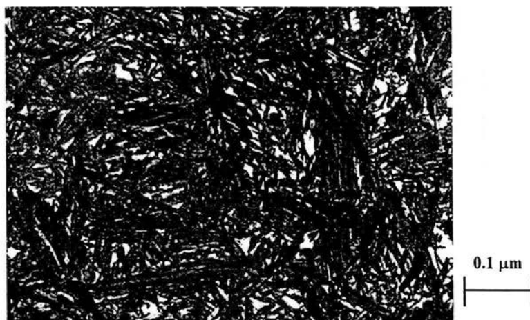
Figura 5.4 Fotomicrografía de la probeta de acero para herramientas AISI O1 sometida al tratamiento subcero a -10\text{ }^{\circ}\text{C} durante 15 minutos. Para revelar la microestructura, la probeta se revinió a 200\text{ }^{\circ}\text{C} durante 2 horas.
