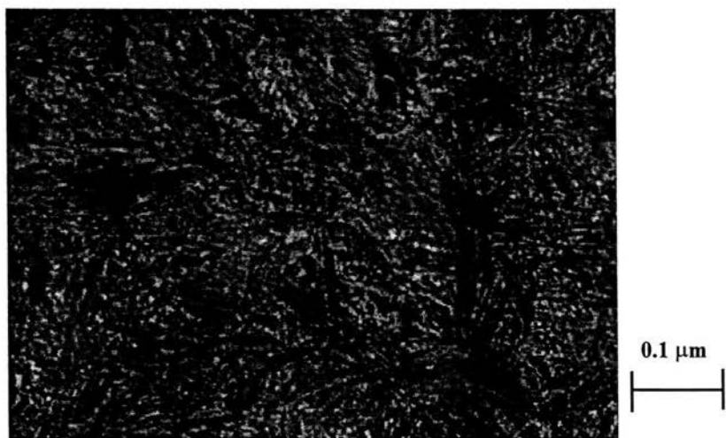
Figura 5.20 Fotomicrografía de la probeta de acero para herramientas AISI O1 templada y tratada criogénicamente durante 15 minutos. Para revelar la microestructura, la probeta se revinió a 200 °C durante 2 horas.
