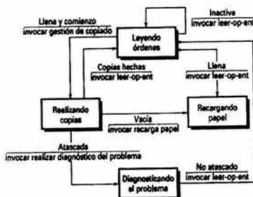
Figura 2. 4.- Ejemplo de diagrama de transición de estados.
