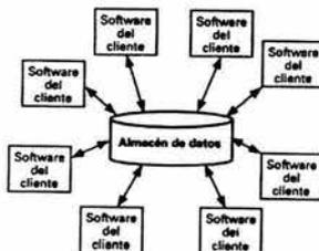
Figura 2. 7.- Arquitectura de base de datos centralizada.
