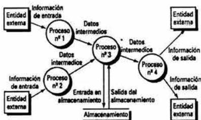
Figura 2. 3.- Ejemplo de diagrama de flujo de datos.
