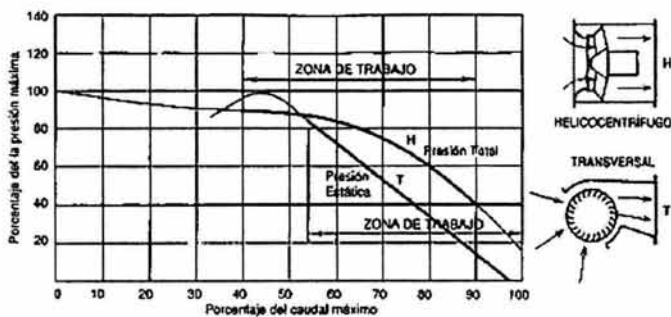
FIGURA 68. RODETES HÉLICO-CENTRÍFUGOS Y TRANSVERSALES.
