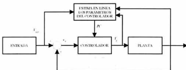
FIGURA 27. DIAGRAMA A BLOQUES DE UN CONTROL ADAPTABLE DIRECTO.
