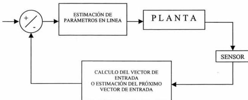
FIGURA 30. DIAGRAMA DE CONTROL ADAPTABLE POR ASIGNACIÓN DE POLOS.
