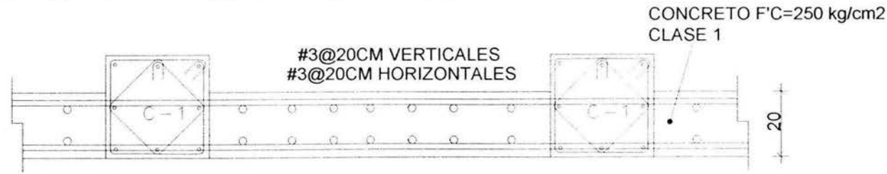
MURO DE CONCRETO MC-1
