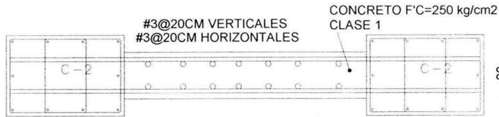
MURO DE CONCRETO MC-2
