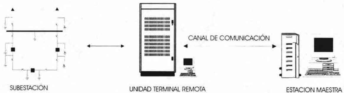
Figura II.1 Enlace directo entre la subestación, la unidad terminal remota y la estación maestra.
