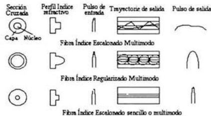
Figura 2.2.2 Índices de refracción y modos de transmisión de la fibra óptica
