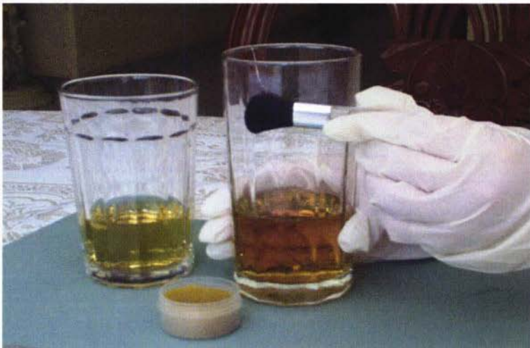
Fotografía 12. Colocación de reactivo para revelar huellas en el vaso.
