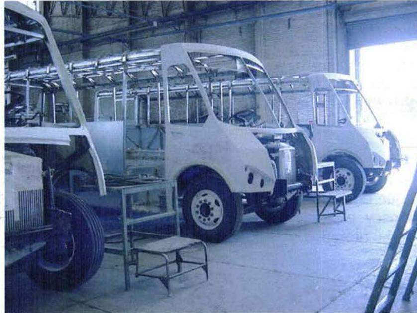
Así ya, una vez terminadas las carcazas, serán montadas sobre la estructura y fijadas por medio de remaches; los elementos, mecanismos y accesorios comerciales restantes son a su vez montados al cuerpo y estructura obtenidos, por medio de tornillería y pegamento en el caso del parabrisas.
