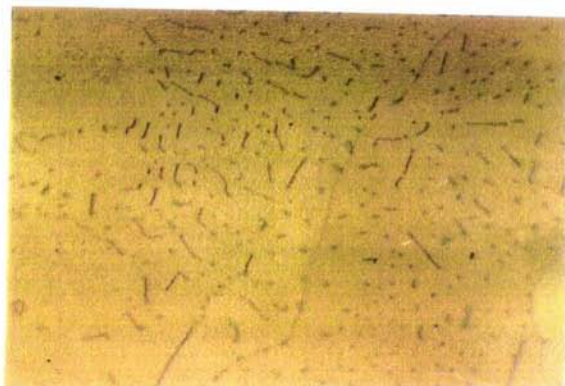
Fotografía 2. Muestra Co solubilizada sin gas con dos tratamientos térmicos de envejecimiento por 3 y 5 horas respectivamente, con 400 X.
