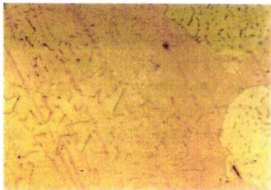
Fotografía 4. Muestra Co solubilizada con gas, con dos envejecimientos por 3 y 5 horas respectivamente, con 280 X.
