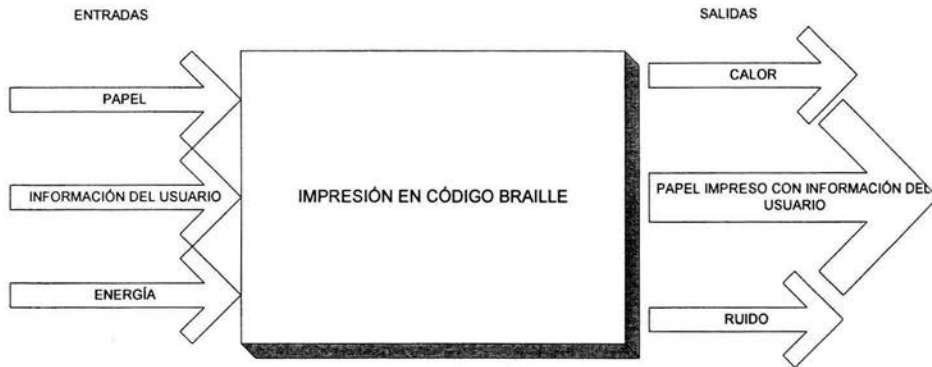
Fig.3.3 Modelo de caja negra aplicado al diseño de la impresora braille.
