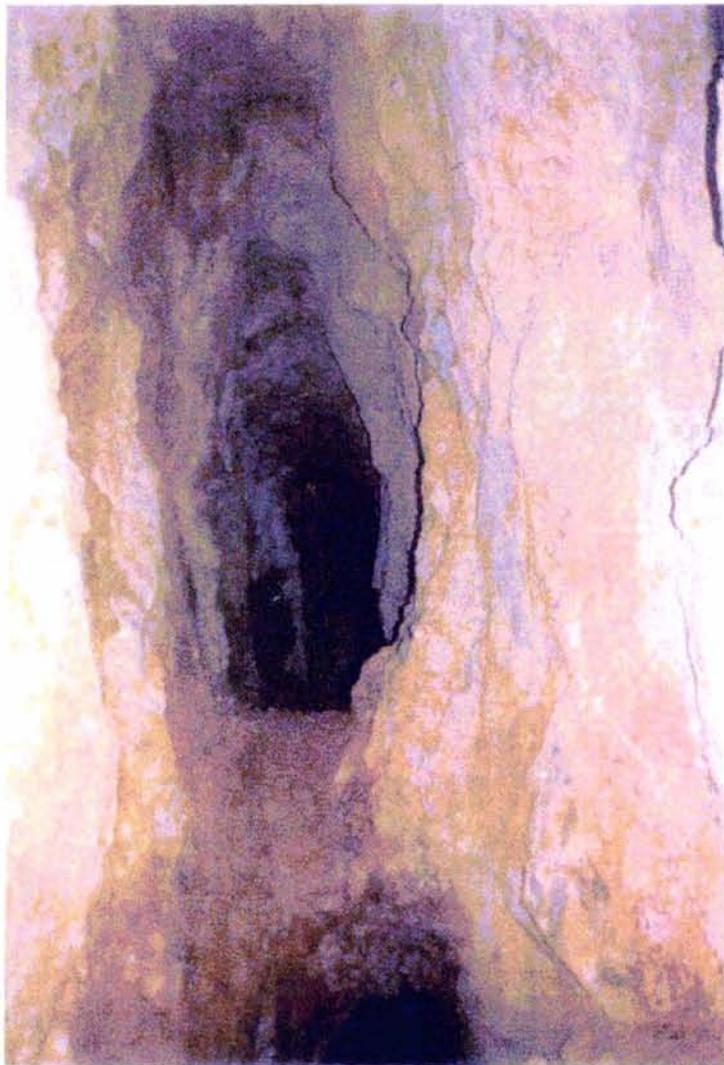
**Fotografía No. 2.** Nivel 2 mostrando un pilar para seguridad
