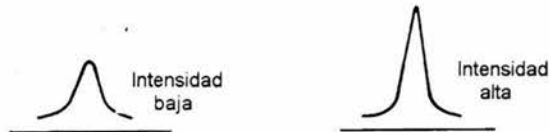
Figura 1.4. Origen de los efectos Stokes y anti-Stokes y sus diferencias en intensidades. La intensidad relativa para cada línea varía con la temperatura. A mayor temperatura existen más moléculas en el nivel de energía V=1 , donde V es el número cuántico vibracional.
