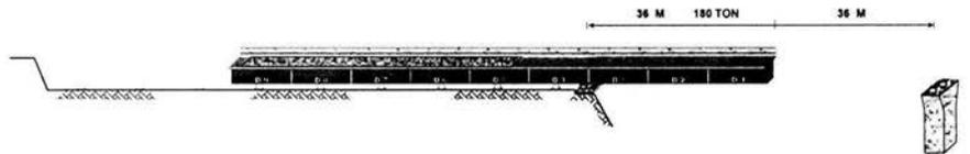
**Figura 1.9** VERIFICADA LA RESISTENCIA EN LOSA, SE EMPUJA VOLANDO LAS DOVELAS 1, 2 Y 3.
