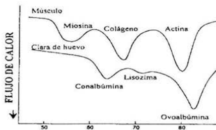
Fig. 20 Termograma característico de la desnaturalización de diferentes fracciones proteicas presentes en la carne y en la clara de huevo. Fuente: Termodinámica y cinética de sistemas alimento entorno Universidad Politécnica de Valencia.
