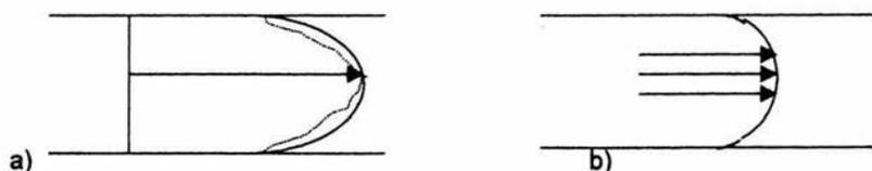
Figura 44. a) Perfiles de flujo para un fluido con comportamiento newtoniano (curva continua), fluido con comportamiento fluidificante a la cizalla (curva discontinua) b) perfiles de flujo para un fluido que requiere un esfuerzo umbral  $\sigma_0$  (Rosental, 2001).
