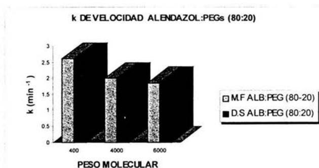
**FIGURA No. 15** K de velocidad de disolución D.S. y M.F. (80:20) en función al peso molecular del PEG
