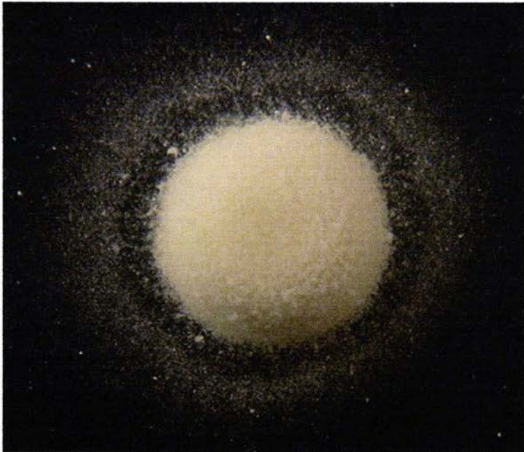
Figura 25. Fotografía de la tableta con 58.5 % de Protanal® en el medio buffer fosfatos pH 6.8 por 3 horas 6 minutos.
