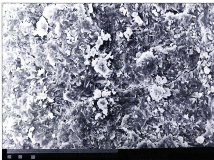
Figura 28. Microfotografía de la superficie de la tableta con 58.5 % Avicel® PH 200 (x 450).
