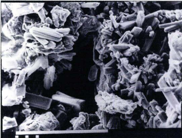
Figura 33. Microfotografía de la tableta (29.25 % Protanal, 29.25 % Avicel PH 102) hidratada por 30 minutos en buffer fosfatos pH 6.8 (x 450).
