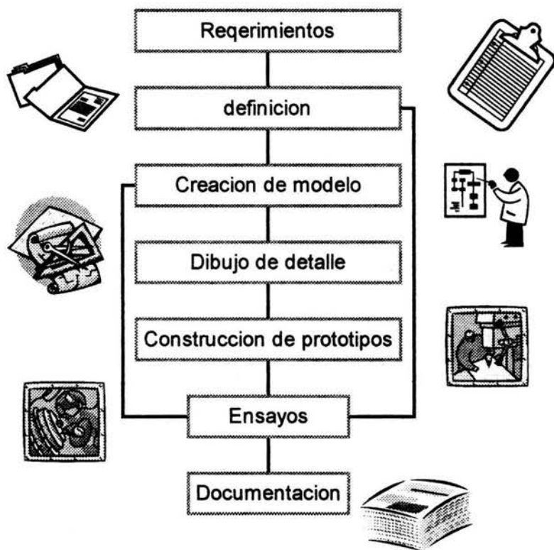
Figura 1.1. -Proceso Clásico de diseño
