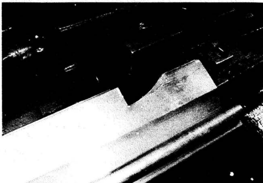
Fig. 5.1 Perfil de aluminio y su operación de corte
