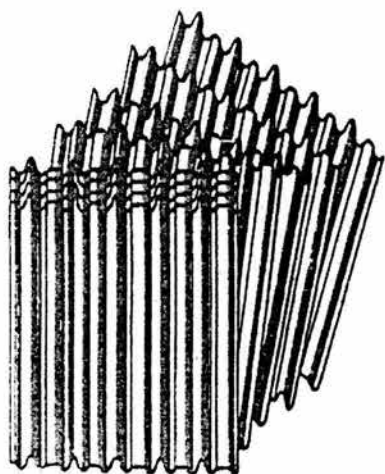
ELEMENTO CALEFACTOR CON ONDULADO DOBLE (SE INSTALA EN EL LADO CALIENTE Y EN LA PARTE INTERMEDIA)
