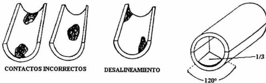
Fig. 2.34 Tipos de contacto en chumaceras.
