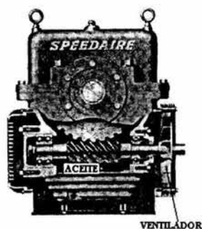
Fig. 2.3 Reductor de velocidad de tornillo sin fin. Este modelo esta refrigerado por circulación de aire alrededor de la superficie exterior del pozo de aceite, la cual esta nervada para aumentar el área de transferencia
