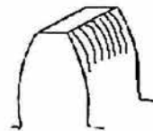
Fig. 2.12 Rayado en la cara del diente
