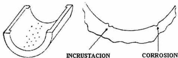
Fig. 2.30 Incrustación de partículas metálicas o arenosas en el metal antifricción.
