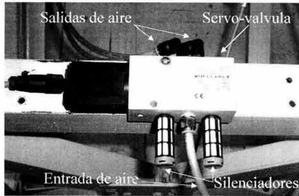
Figura 4.15. Esquema de la servo-válvula Foto 4.12. Servo-válvula montada en la mesa
