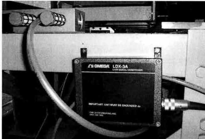
Foto 4.22. Acondicionador para el sensor de desplazamiento
