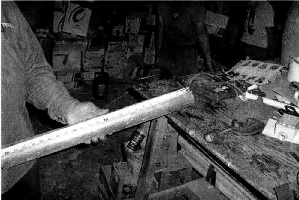
**DESPUES DEL TRAZO Y DE HABER ELABORADO EL PROGRAMA DE HABILITADO Y CORTE DE LA TUBERIA, ES PRECISO REALIZAR EL DIMENSIONAMIENTO PARA EL CORTE PRECISO DE LOS TRAMOS A UTILIZAR.**
