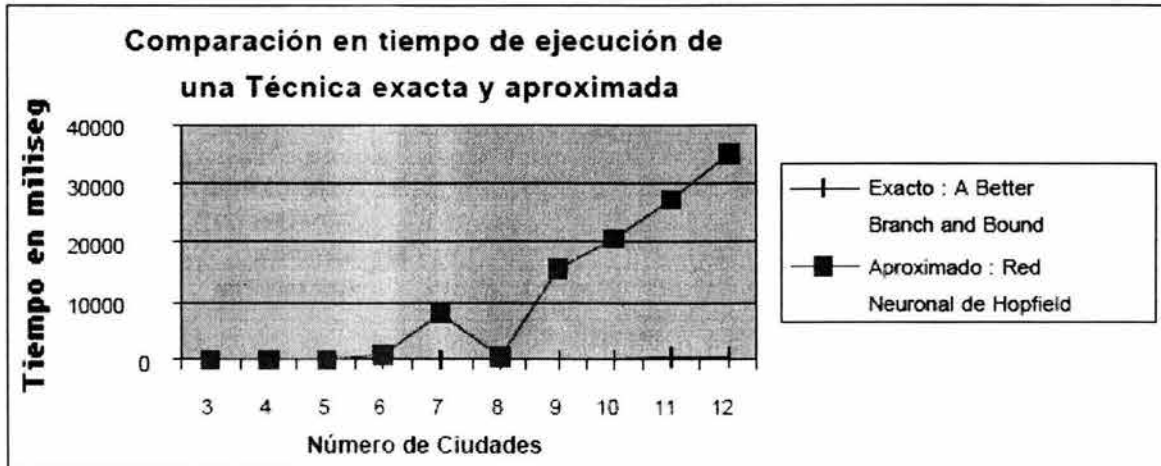
Figura 4.9 Comparación en tiempo de ejecución del algoritmo red neuronal de hopfield y a Better Branch and Bound
