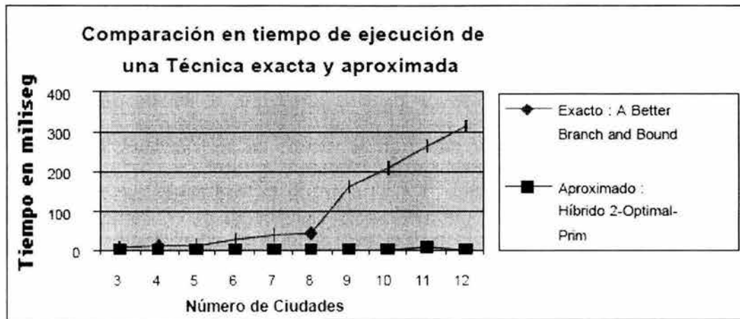
Figura 4.7 Comparación en tiempo de ejecución del algoritmo Adaptación Prim y a Better Branch and Bound
