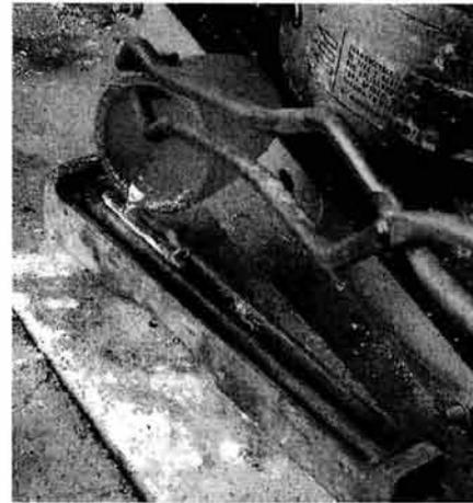
Vaciado de la aleación en una lingotera
