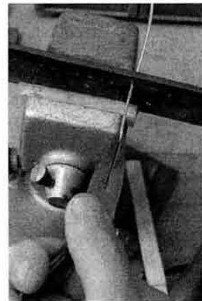
Se aplica la fuerza de tracción sujetando bien las pinzas se repite la acción hasta obtener el diámetro deseado
