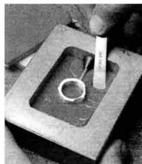
Colocación de las láminas de silicona alrededor del modelo
