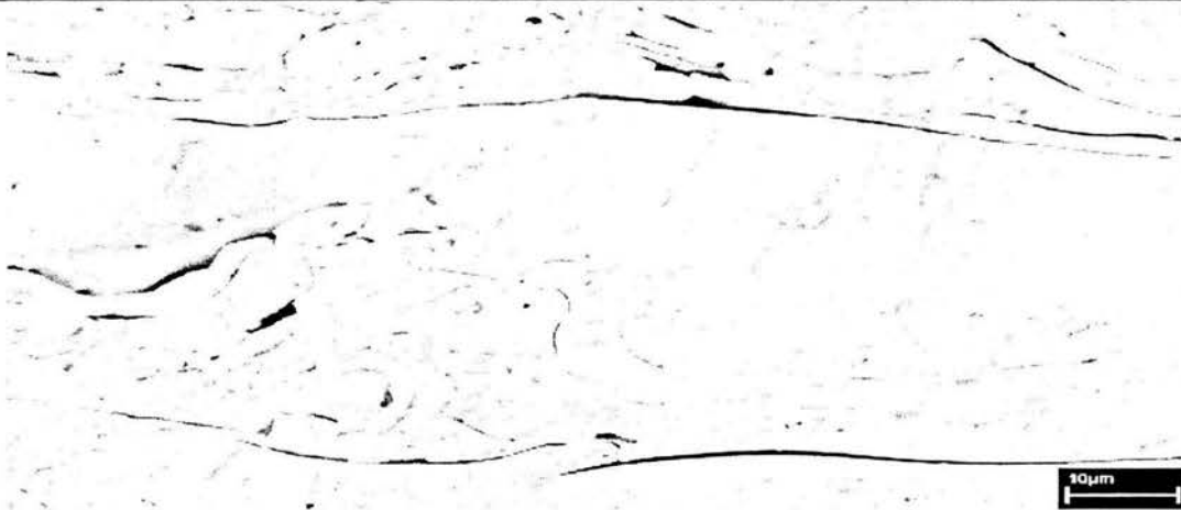
Figura 3.45 Microestructura correspondiente al cuadro de la parte inferior G, constituida por granos columnares y equiaxiales.
