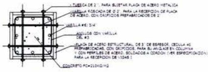
DETALLE TIPO PLACAS PARA RECEPCION DE VIGAS
