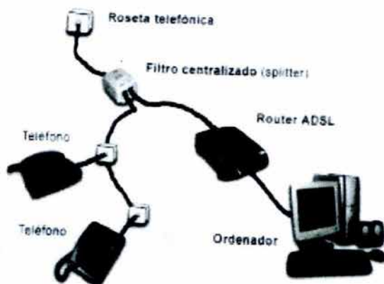
Figura 17 Instalación con un Splitter.
