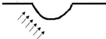
Figura 2.2 Irregularidad superficial e incidencia de ondas elásticas
