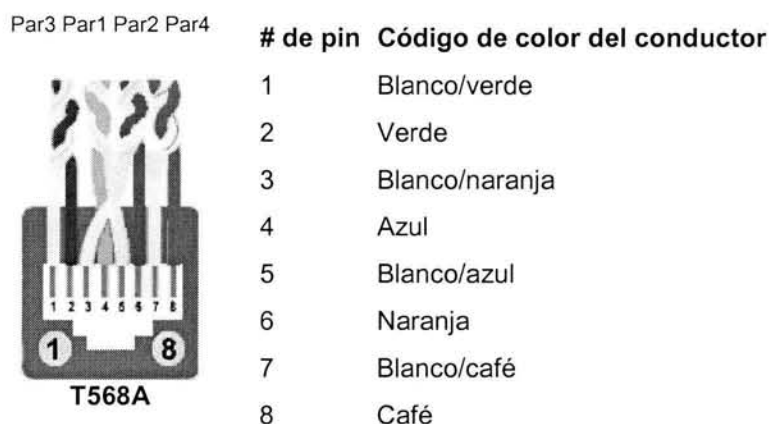
Figura 2-7. Asignación de pares en jack modular de ocho posiciones para UTP.
