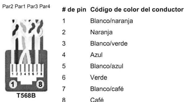
Figura 2-8. Asignación de pares en jack modular de ocho posiciones para UTP.
