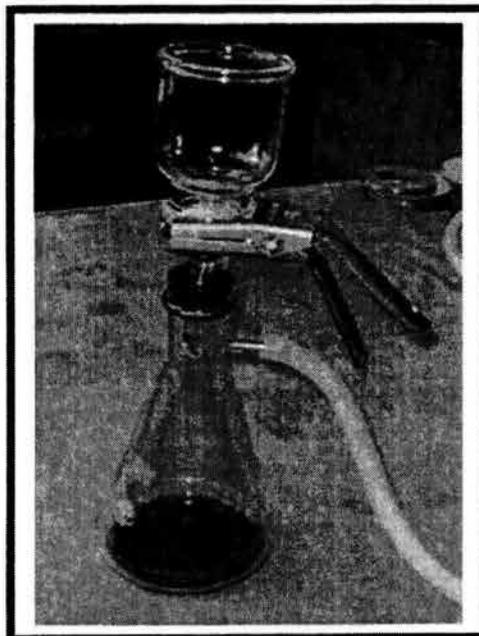
Figura 4.3. Sistema de filtración
