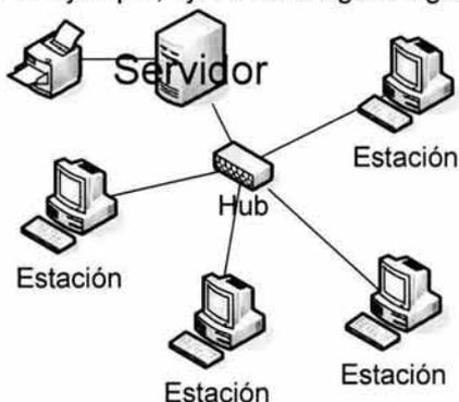
En ella se muestra una disposición física de configuración en estrella. Cada estación envía y recibe señales por el mismo cable.
