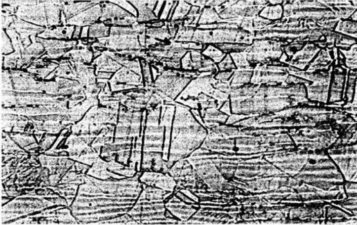
Figura 4.2 Micrografía del Acero AISI 304. Granos de austenita con maclas. Aumento:500x
