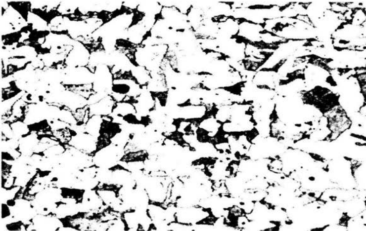
Figura 4.1 Micrografía del acero ASTM A56. Perlita en matriz ferrítica. Aumento:500x
