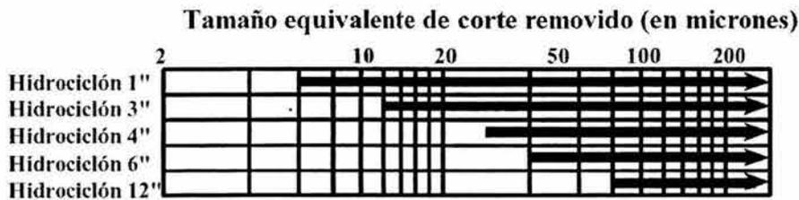
Figura 7.7: Gráfico de amplitudes de operación del hidrociclón. Los ciclones remueven partículas aproximadamente del mismo tamaño; los ciclones grandes pueden manejar volúmenes mucho más grandes de fluido de perforación.
