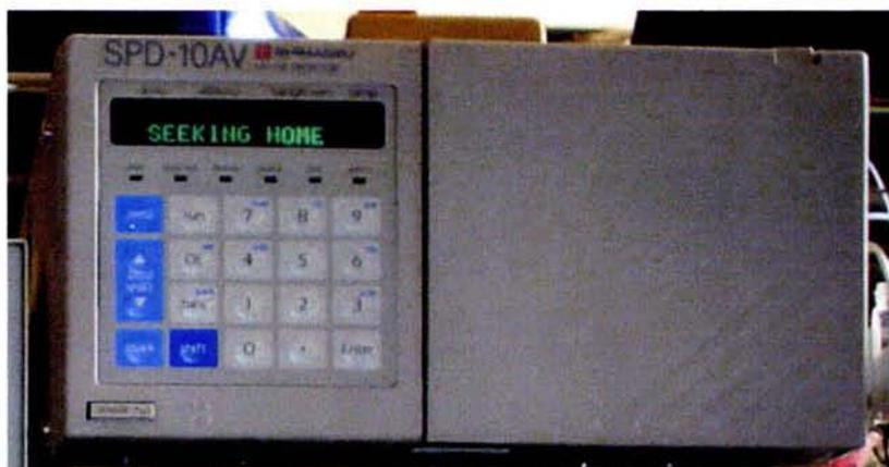
Figura 2.11 Detector de UV-Visible de longitud de onda variable marca Shimadzu.
