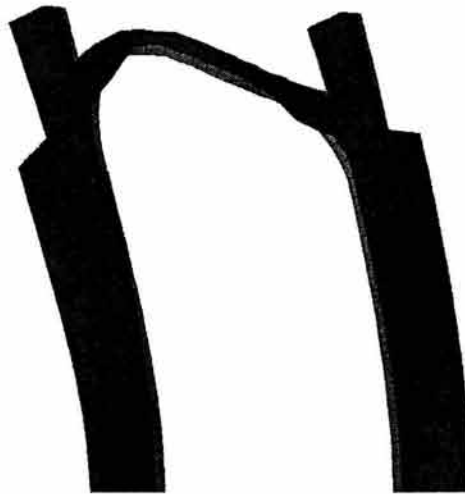
Fig. IV.4.9 Deformada en el instante de máximo desplazamiento en la clave de la bóveda.
