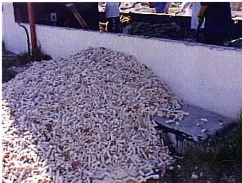
Fotografía 3. Olote de maíz utilizado como agente mejorador de la porosidad de la materia orgánica.
