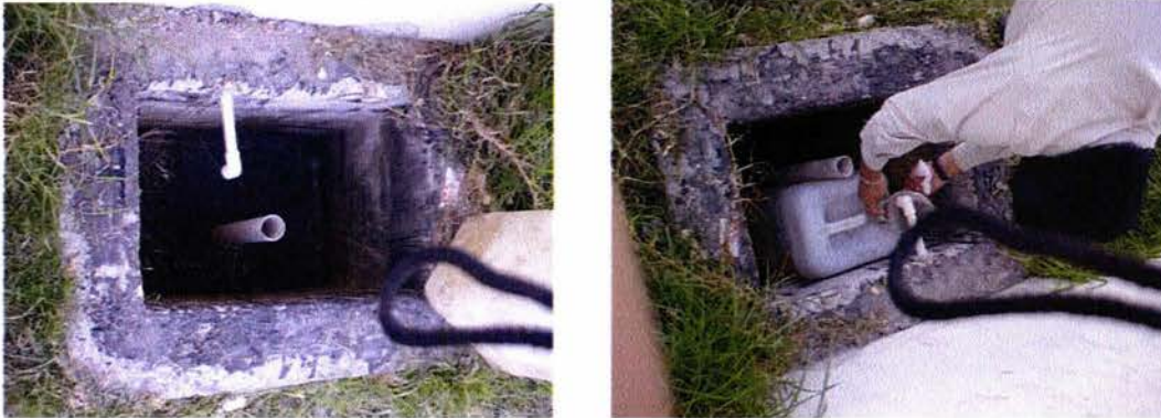
Fotografías 6 y 7. Detalle de los registros colectores de lixiviados. A la derecha se observa un garrafón que permite tener mayor control de los mismos para su cuantificación y análisis.
