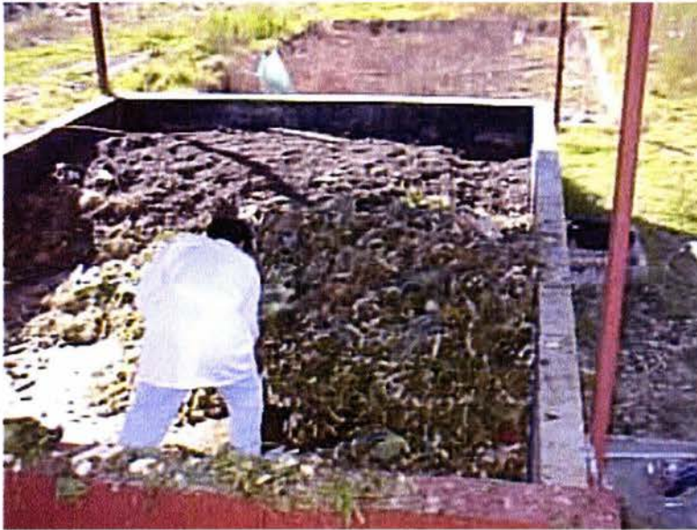
Fotografía 4. Homogeneización a pala de la materia orgánica y el olote.
