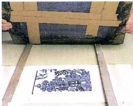
Se utilizan palos para subir la rejilla por encima del azulejo para que pueda levantarse después de aplicar la tinta con la espátula de caucho. Fig. 61
