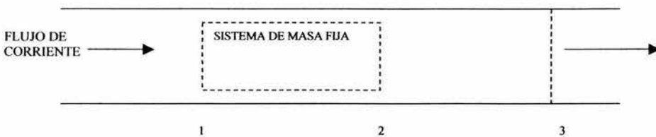
Figura 2.2. Movimiento de un fluido en el interior de un tubo.
