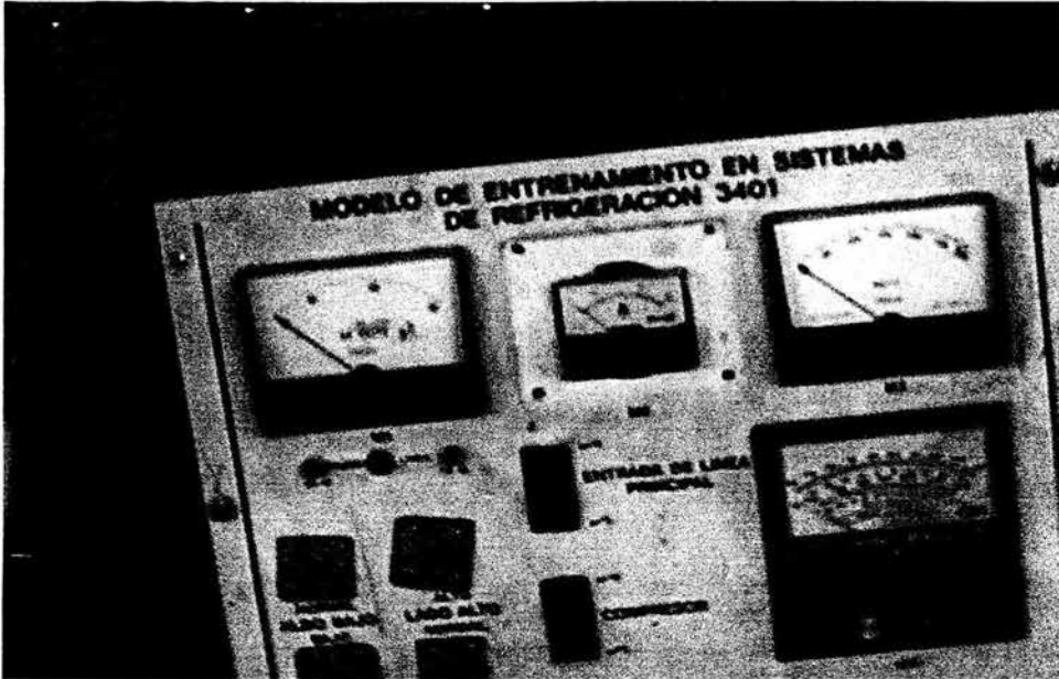
Figura 6.27. Vista general del tablero de instrumentación del equipo de refrigeración marca "Labvolt modelo 3401"
