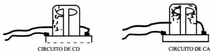
Figura 1.12. Identificación de la corriente con una lámpara de neón.
