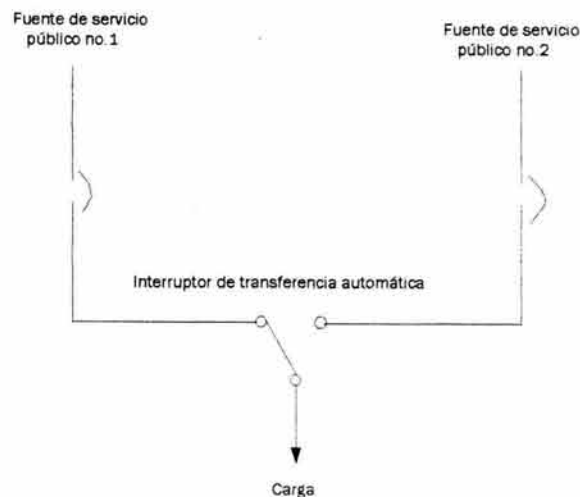
Figura no. 1. Sistema de dos fuentes de suministro utilizando un switch de transferencia automática.
