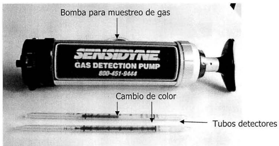
Figura 3.3 Sistema GASTEC SENSIDYNE<sup>®</sup> para la cuantificación de  $H_2S$
