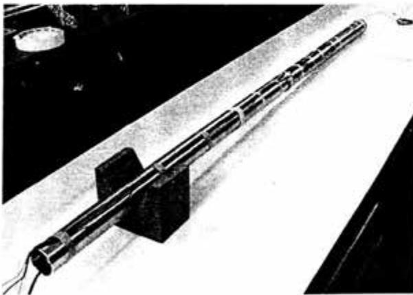
Figura 6.11. Camisa exterior del contenedor instrumentada con sensores de temperatura.
