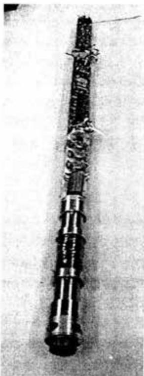
Figura H.2. Instalación del CCL.
