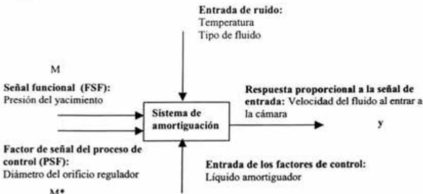
Figura 4.30. Diagrama P para el caso dinámico con dos factores de señal
