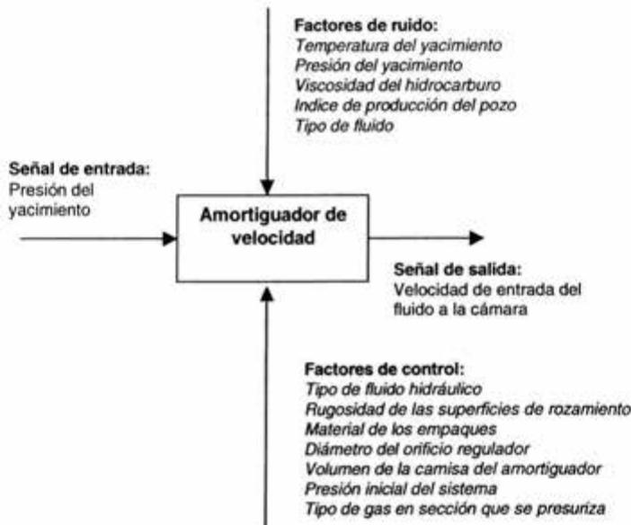
Figura 4.29. Diagrama P para el sistema de amortiguación
