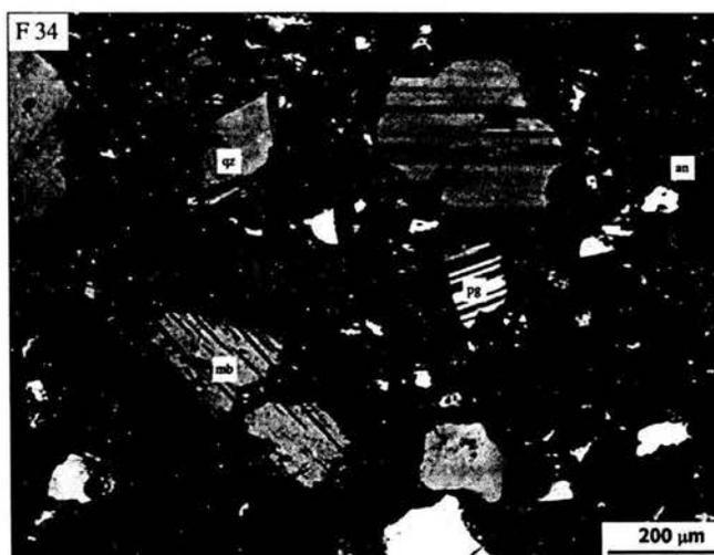
Figura 33. Fotomicrografía, muestra 50, luz transmitida, objetivo de 10x. Mica (mb), cristales de cuarzo (qz) y esquirlas de vidrio (ev).
