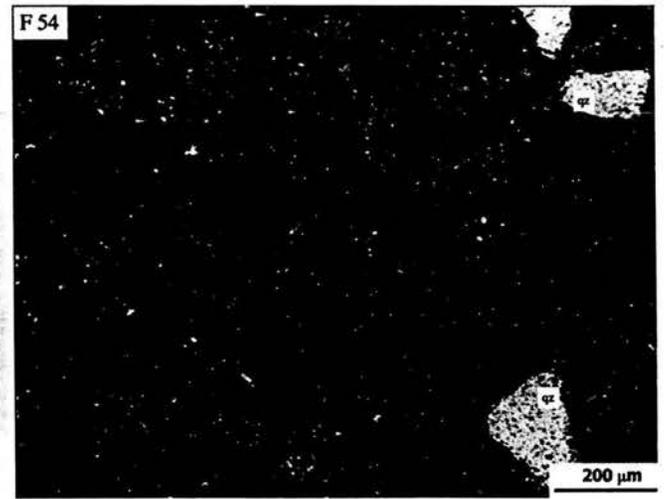
Figura 53. Fotomicrografía, muestra 18, luz transmitida, objetivo de 10x. Vista general, porosidad en la arcilla, cuarzo (qz) y esquirlas de vidrio (ev).
