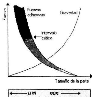
Figura 5. Relación entre fuerzas adhesivas y el tamaño de las partes
