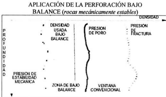
Figura 1V.13. Definición de la estabilidad mecánica de la formación en términos de densidad equivalente.
