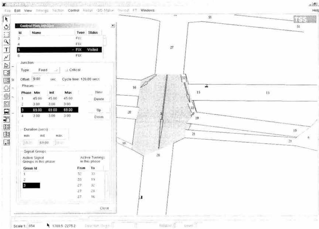
Figura 4.8. Asignación de la secuencia de fases en las intersecciones del sistema vial.
