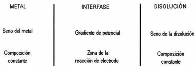
Figura II-8. Sistema electródico fundamental.
