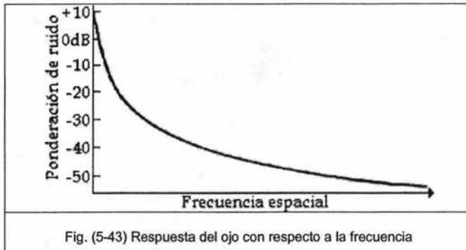
La **figura (5-43)** muestra que la sensibilidad que tiene el ojo al ruido, vemos que este disminuye con el incremento de la frecuencia, la sensibilidad máxima y una concentración mayor de energía se encuentra alrededor de la esquina superior izquierda de la matriz obtenida de la transformación, como resultado, el coeficiente superior izquierdo suele tratarse como un caso especial y se deja sin modificar.
