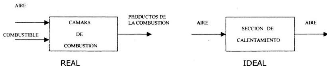
Figura 3.1. Nos muestra como el proceso de combustión es sustituido por un ciclo de adición de calor en ciclos ideales.
