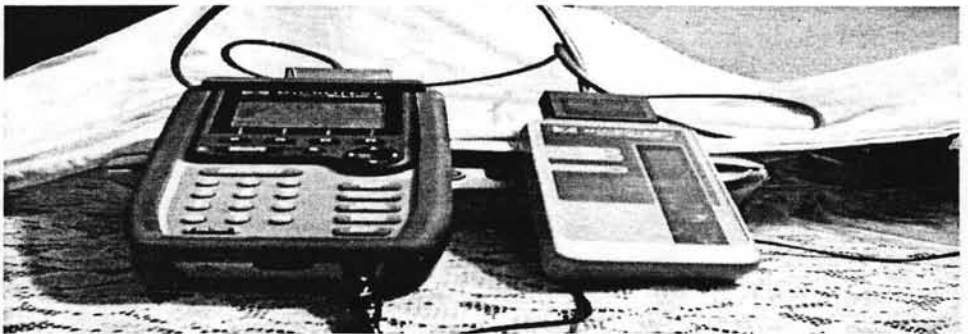
Figura VI.26 Hacer pruebas con cables UTP.
