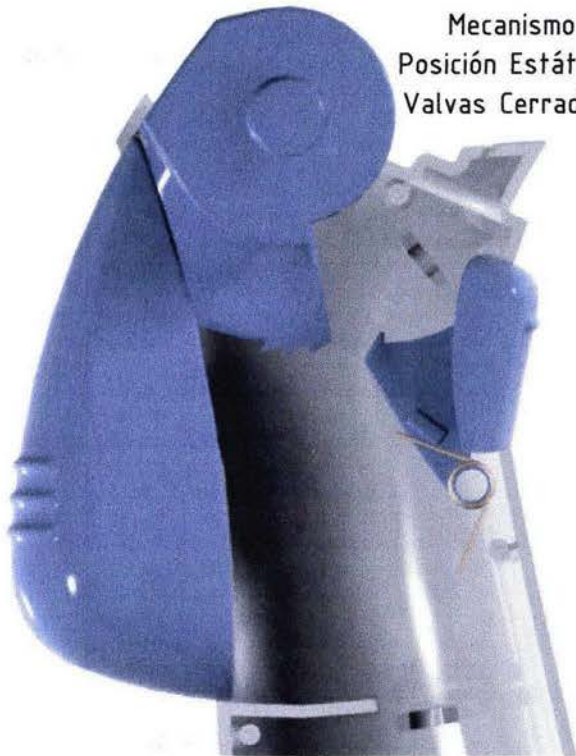
Posición de los componentes cuando se abren o cierran las valvas.
